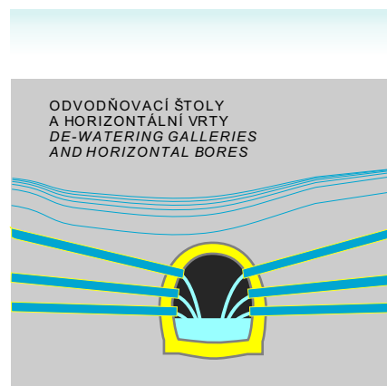
Jímání a odvodňování Pumping and de-watering
